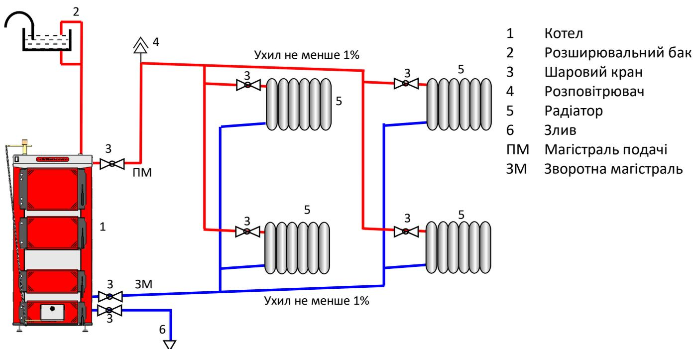
Рис. 13 Схема відкритої системи опалення з гравітаційною циркуляцією
