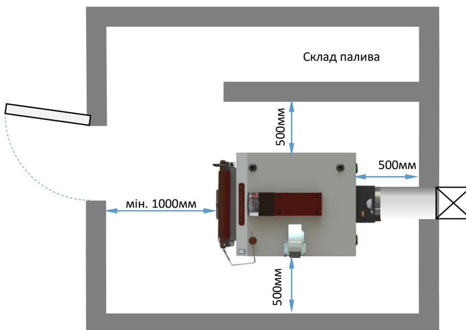
Рис 9 Схема розташування котла в паливній.
