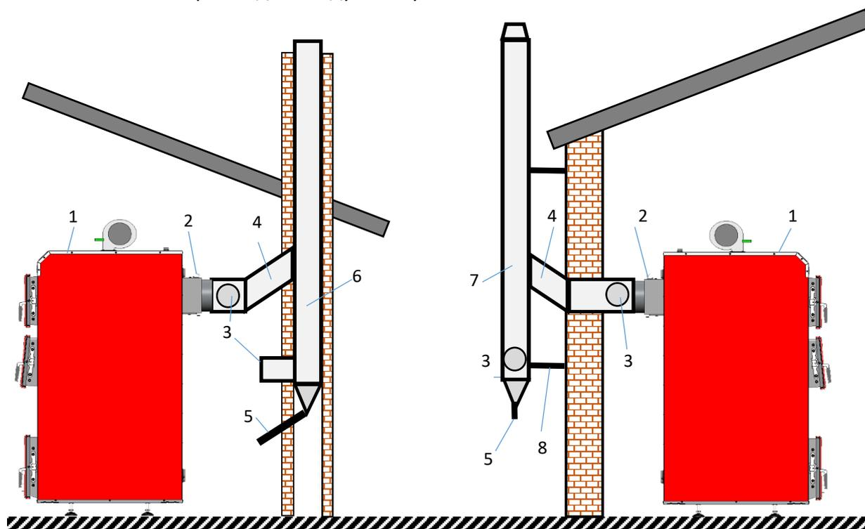
Рис 11 Рекомендована схема підключення котла до димоходу.
